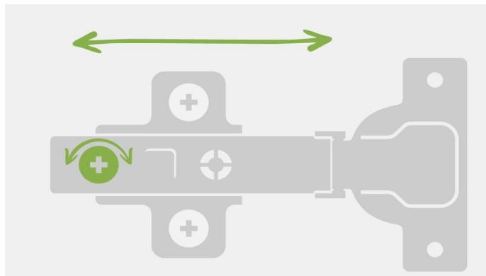
Mit der hinteren Schraube kann der Abstand (Fuge) zwischen Tür und Möbel reguliert werden. Dafür die Schraube lösen, Tür vorsichtig nach vorne ziehen oder nach hinten schieben und Schraube wieder festziehen.
