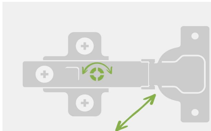
Mit der vorderen Schraube kann die Tür in der Breite verstellt werden. Wird die Schraube nach links gedreht, wird die Tür zur rechten Seite verstellt. Wird die Schraube nach rechts gedreht, wird die Tür zur linken Seite verstellt.
