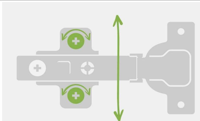
Die beiden Schrauben der Montageplatten lösen, die Tür in der Höhe justieren, Schrauben wieder anziehen.
