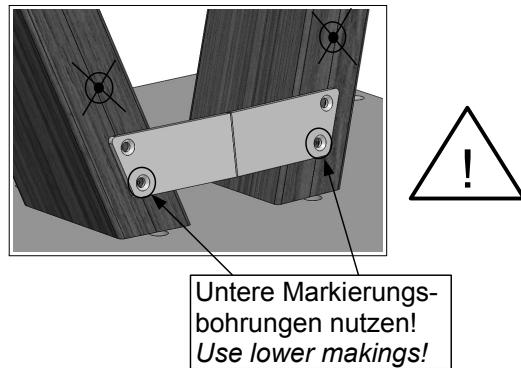
3. Die Bolzen der Tischbeine in die im Bild gezeigten Löcher stecken. Jeden Bolzen mit einer Unterlegscheibe und einer Mutter fixieren.
