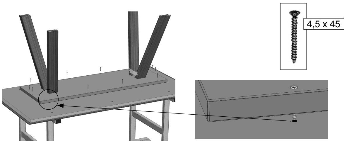
4. Beim Anschrauben der Sperrholz-Platte des vormontierten Unterbaus die Markierungs-Bohrungen nutzen.
