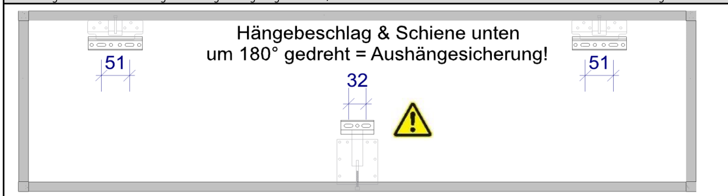
Abbildung 2: Position der Hängebeschläge Hängeregal 8216/8217
